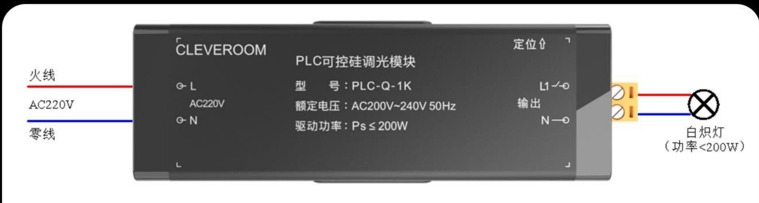
PLC可控硅调光模块控制白炽灯调光接线示意图
