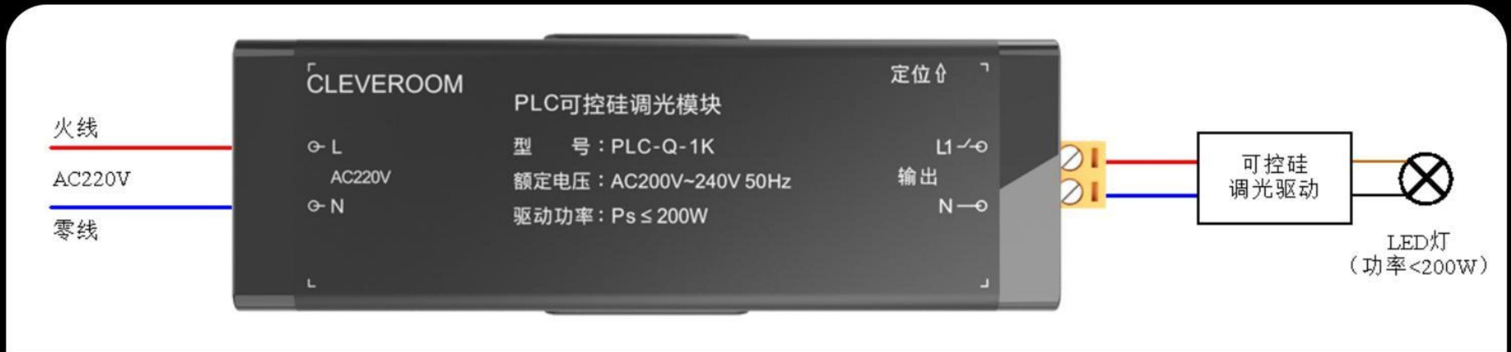
PLC可控硅调光模块控制LED调光接线示意图
