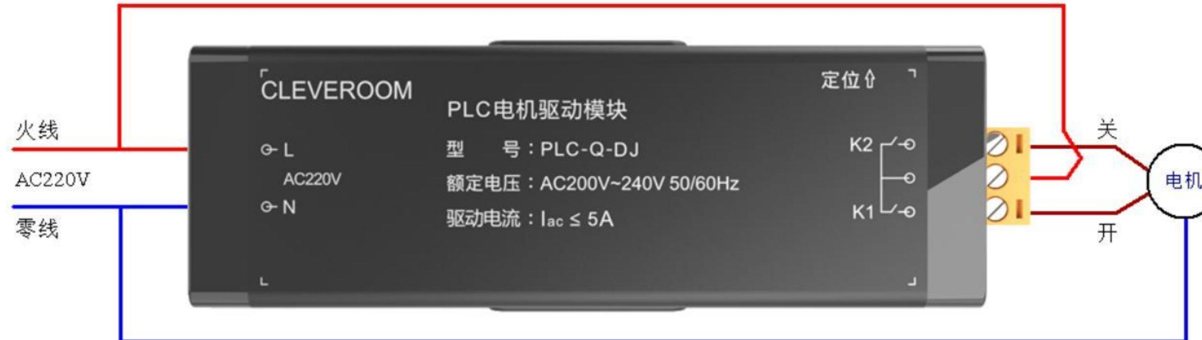
强电直接驱动方式接线示意图
