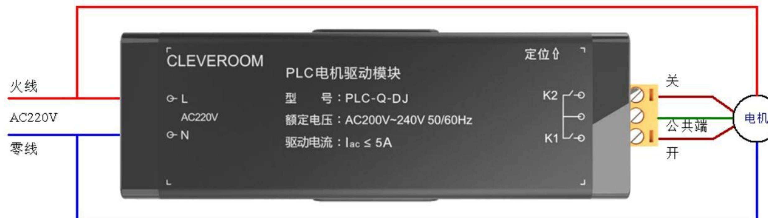
干接点控制方式接线示意图
