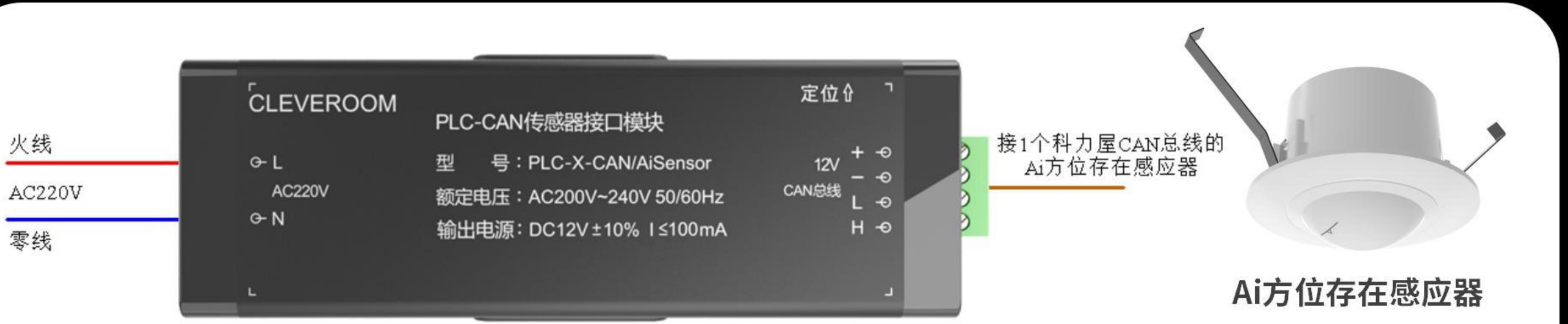
PLC-CAN传感器接口模块(“PLC-X-CAN/AiSensor”型号)接线示意图
