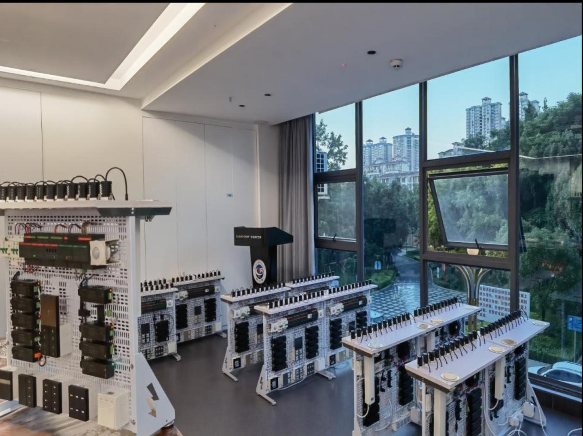
科力屋总部实训室配置有10多套PLC实训装置，均不安装阻波器，所有装置共享同一组零火线供电，但每套实训装置完全相互独立、操作互不干扰。
