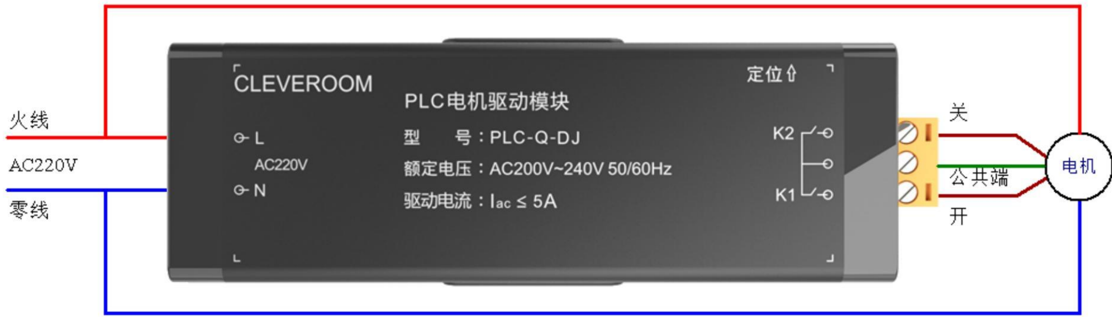
干接点控制方式接线示意图
