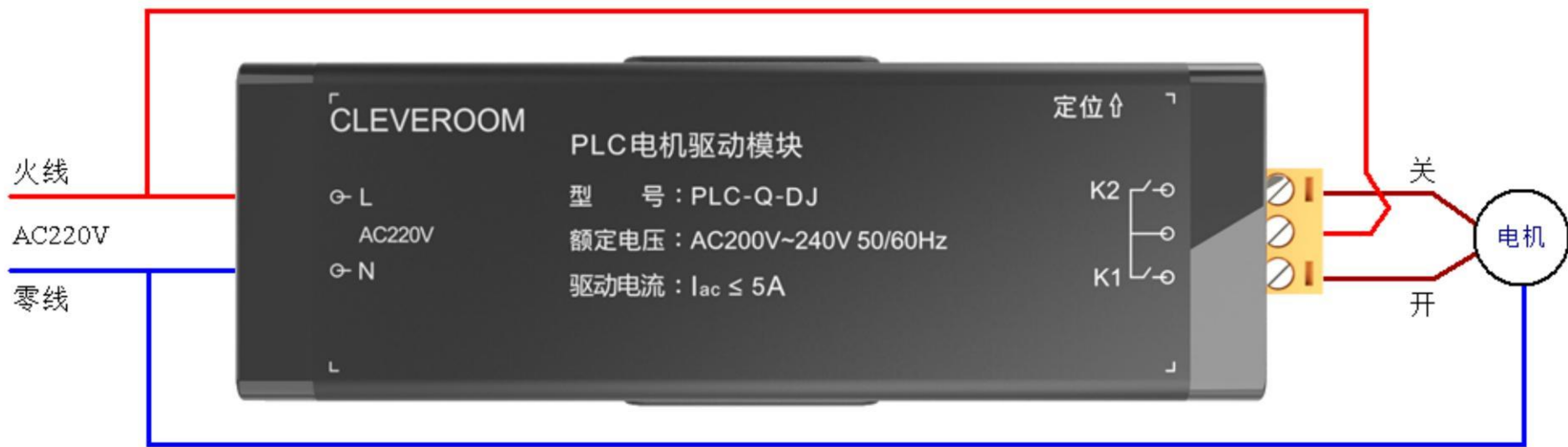
强电直接驱动方式接线示意图
