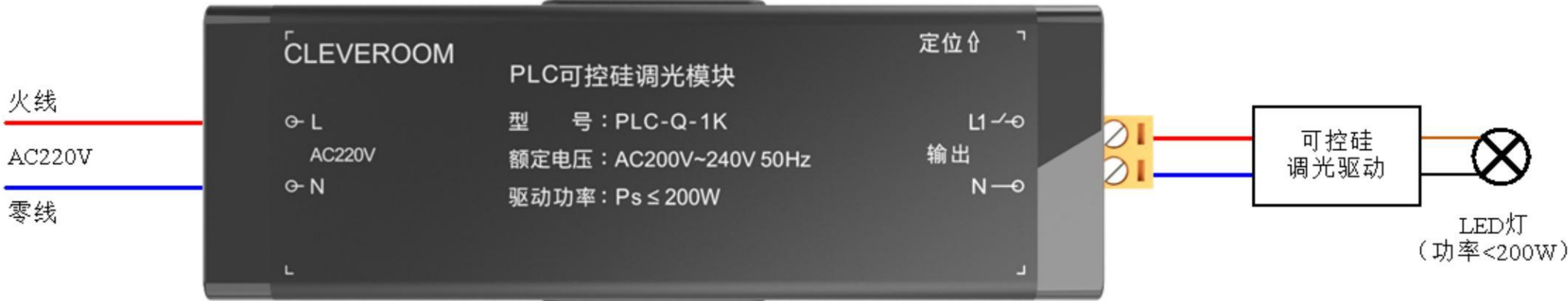
PLC可控硅调光模块控制LED调光接线示意图
