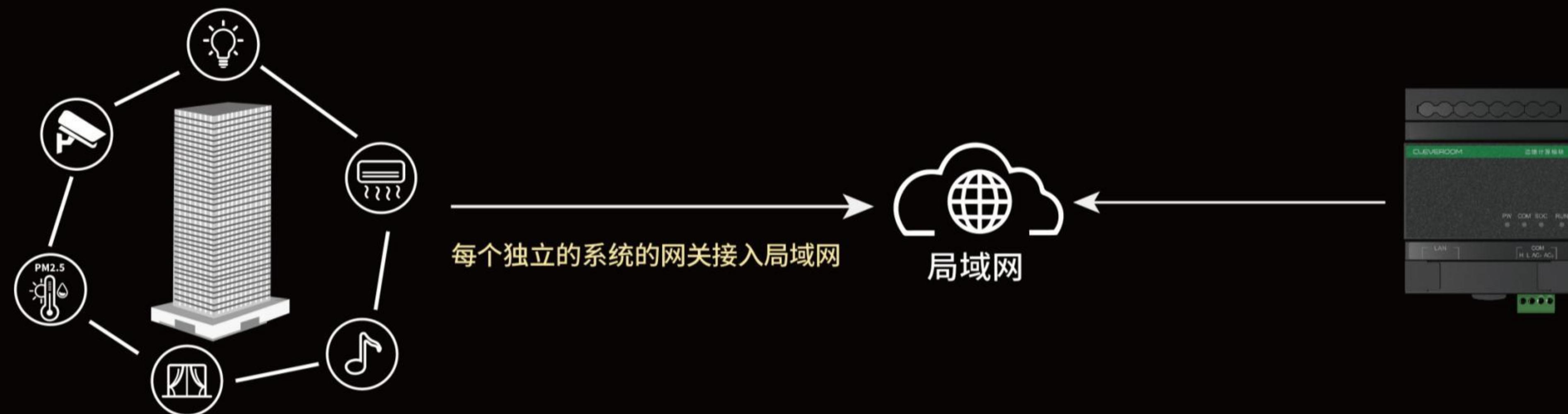
每1/2层构建为一个独立的科力屋PLC/CAN系统，每个系统的网关通过M1/M2边缘计算模块融合为一个大系统
